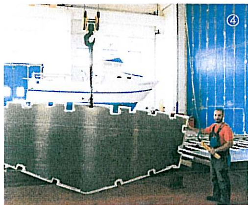
FIG. 4 - DOPO IL TAGLIO Componente in alluminio tagliato con waterjet. Sullo sfondo, una delle imbarcazioni realizzate dalla TSI.
